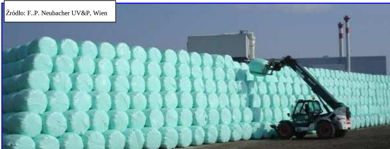
Okresowe składowanie nadmiarowych ilości odpadów przed spaleniem w instalacji ZTPOK
